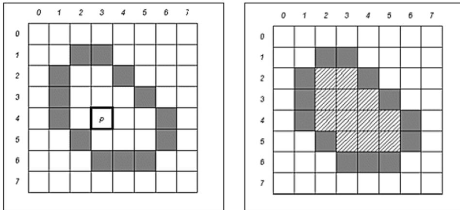
Pour effectuer le remplissage, on doit aller dans toutes les directions à partir du point  $p$ . Ceci ressemble au parcours d'un arbre avec les noeuds de quatre fils. La procédure suivante permet de résoudre le problème en utilisant une pile.
