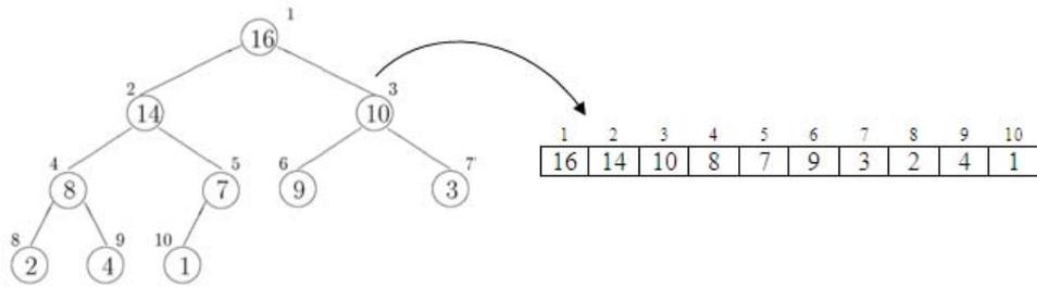
On remarque sur le tableau obtenu que le fils gauche d'un élément d'indice  $i$  se trouve toujours s'il existe à la position  $2i$ , et son fils droit se trouve à la position  $(2i + 1)$  et son père se trouve à la position  $i/2$ . Les opérations d'ajout et de retrait sur le tas statique se font de la même façon que dans le cas du tas dynamique. Avec ce principe les opérations d'ajout et de retrait se font d'une manière très simple et extrêmement efficace.
